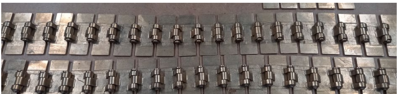
Le tapis de transport avant et après nettoyage.
