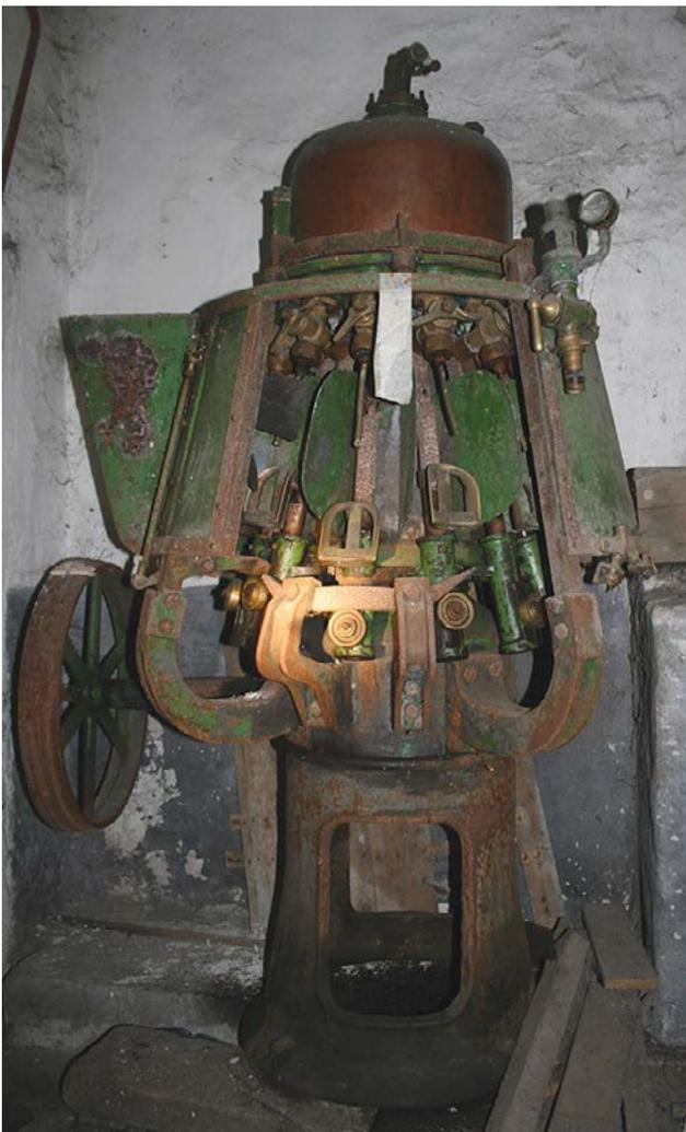
Die Dreh-Abfüllanlage aus Mellier, von der Teile abmontiert wurden um die zweite Maschine zu vervollständigen.
