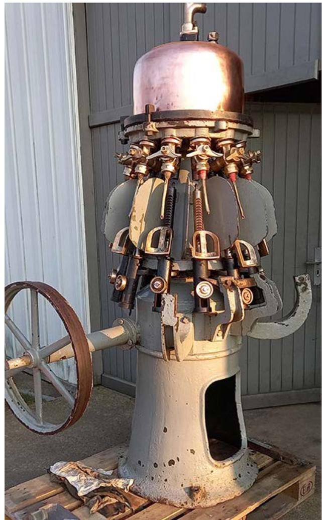
Die Dreh-Abfüllmaschine aus Niederkerschen, nach der Renovierung.
