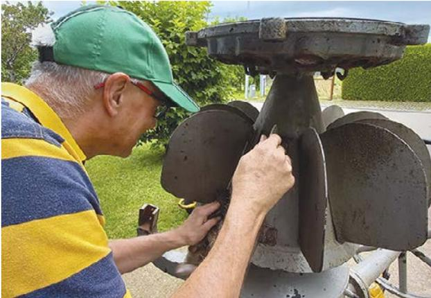
Die graue Abfüllanlage wurde komplett auseinander gebaut und gereinigt. Gebrochene Teile wurden geschweißt und das Ganze anschließend wieder zusammengebaut.
