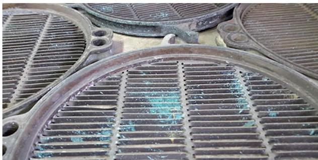
Les plaques de filtre en laiton avant le sablage. Les grands ronds de coton, appelés « masse », étaient placés dans le creux du rond.
