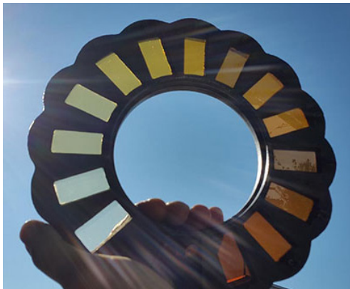
Das Farbrad, demontiert und gegen das Sonnenlicht gehalten.
