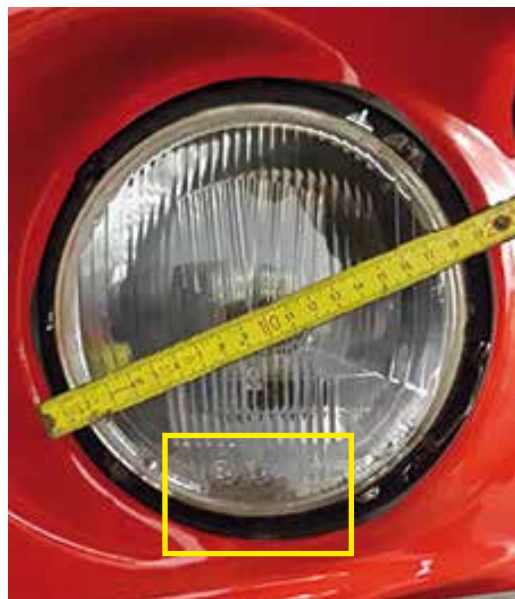
Phare original du camion. Notez la présence de rouille sur le miroir parabolique du phare.
