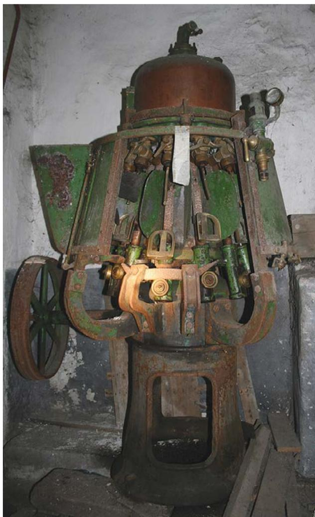
La soutireuse rotative de Mellier, de laquelle des pièces ont été démontées pour compléter la deuxième machine.
