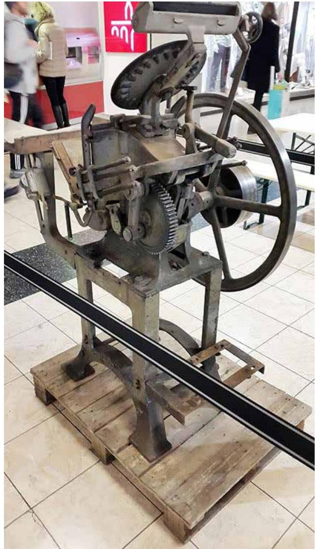
L'imprimante de sous-bocks sur laquelle les matrices d'impression pouvaient être fixées.
